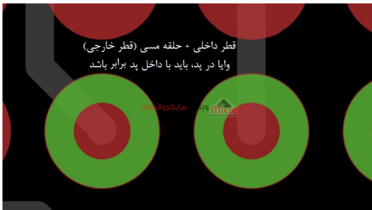
روش استفاده از Via در Pad
