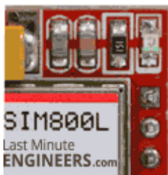
وضعیت روشن بودن ماژول و برقرای اتصال اینترنت GPRS
