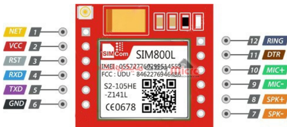
مشخصات پایه ماژول SIM800L
