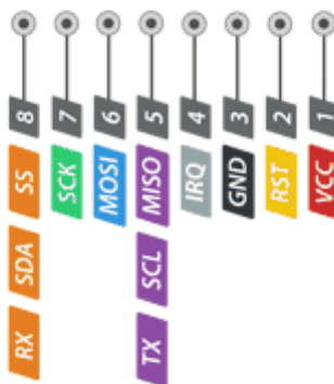
مشخصات و پایه های ماژول RFID Reader RC522
