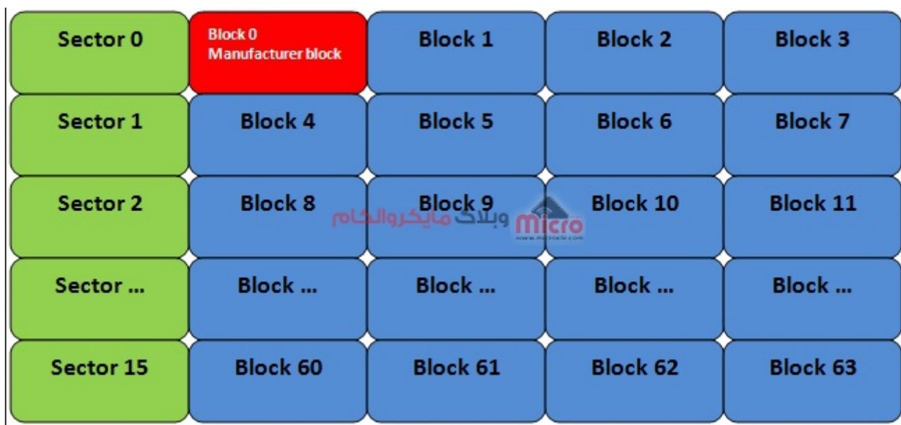
تقسیم بندی حافظه داخلی مارت های RFID نوع مایفر
