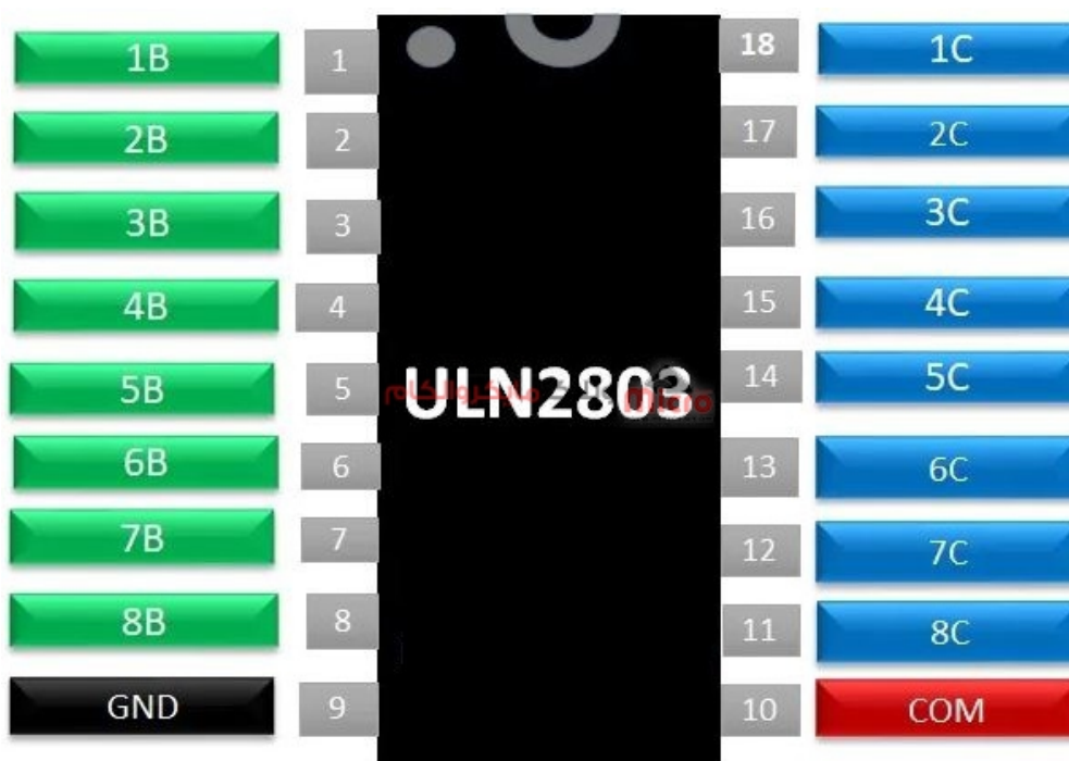
پایه های IC درایور ULN2803
