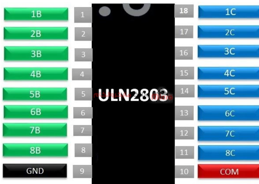
پایه های IC درایور ULN2803
