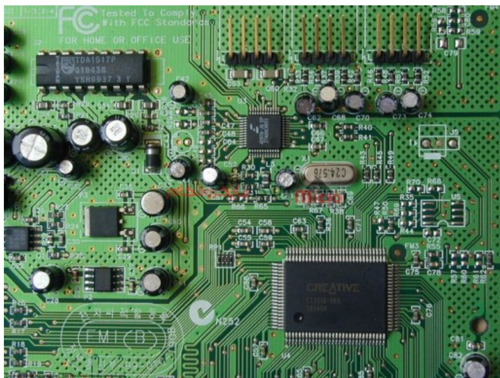
تصویر یک PCB با خازن دیکوپلینگ و خازن های پاس
