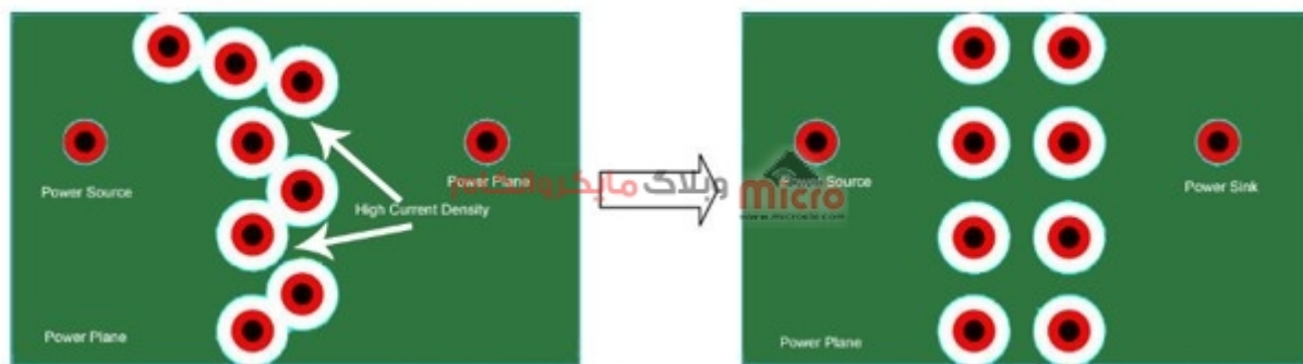
قرار گیری وایا به شکل منظم برای کاهش اثر hotspot در PCB سرعت بالا
