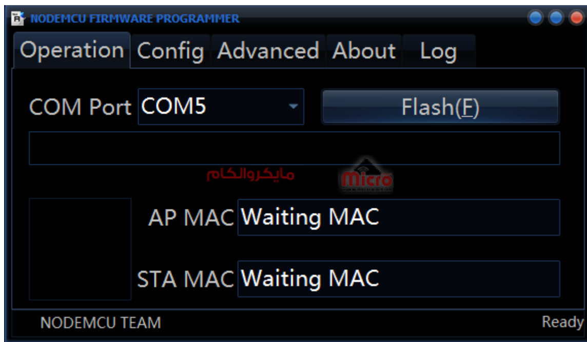
تنظیمات نرم افزار NodeMCU FirmWare Programmer برای نصب فریمور ماژول ESP8266
