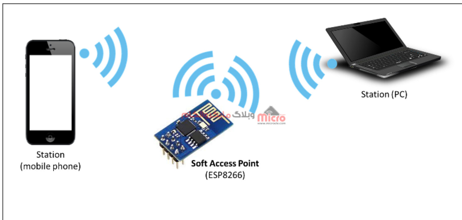
حالت و مد کاری Access Point اکسس پوینت در ماژول ESP8266
