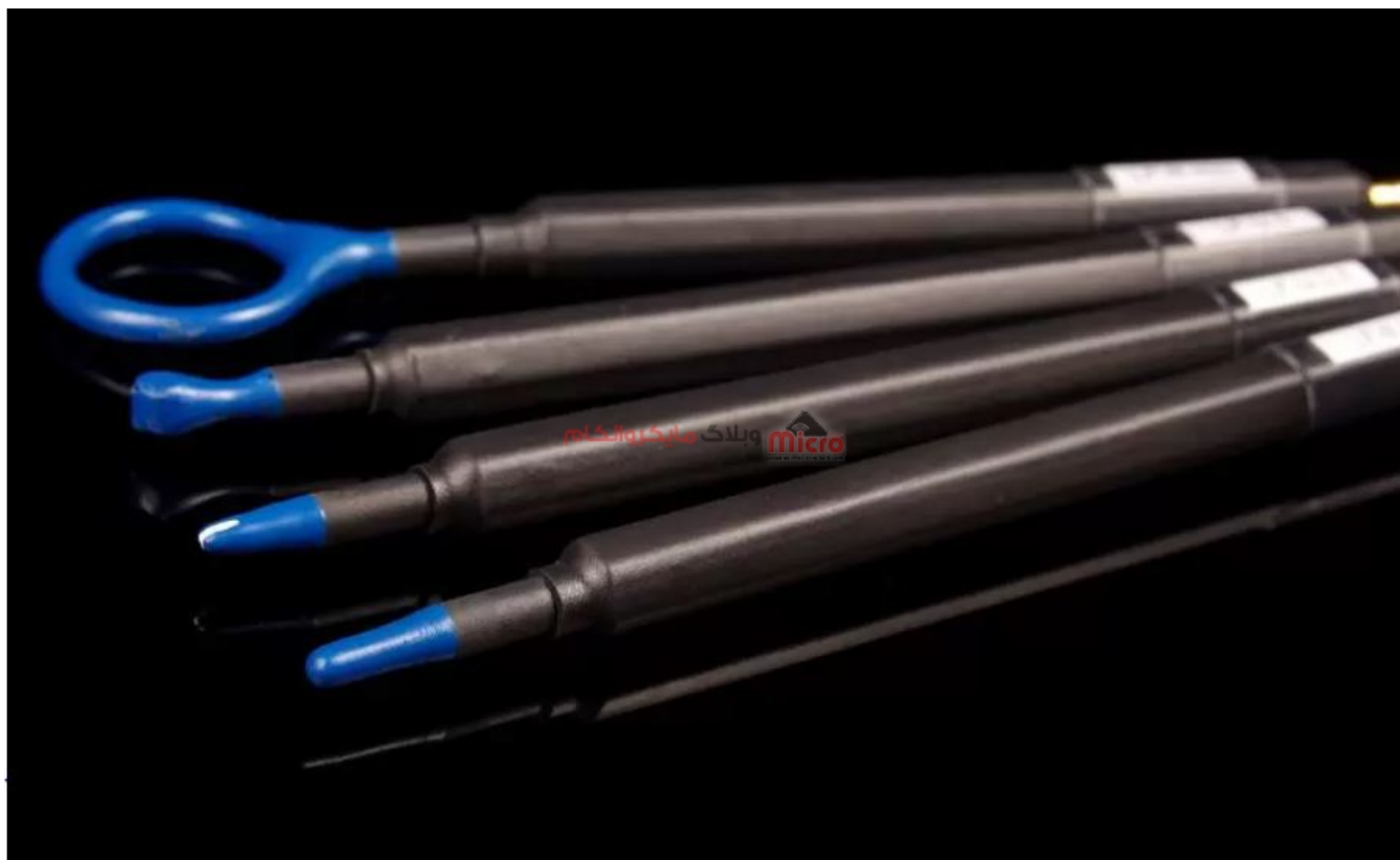
استفاده از اسپلِسکوپ و پراب گزینه مناسبی برای شناسایی نویز ها در PCB می باشد
