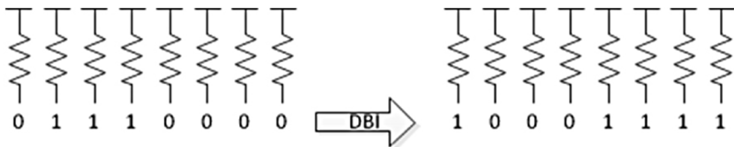
قابلیت (Data Bus Inversion) (DBI) در حافظه های DDR4
