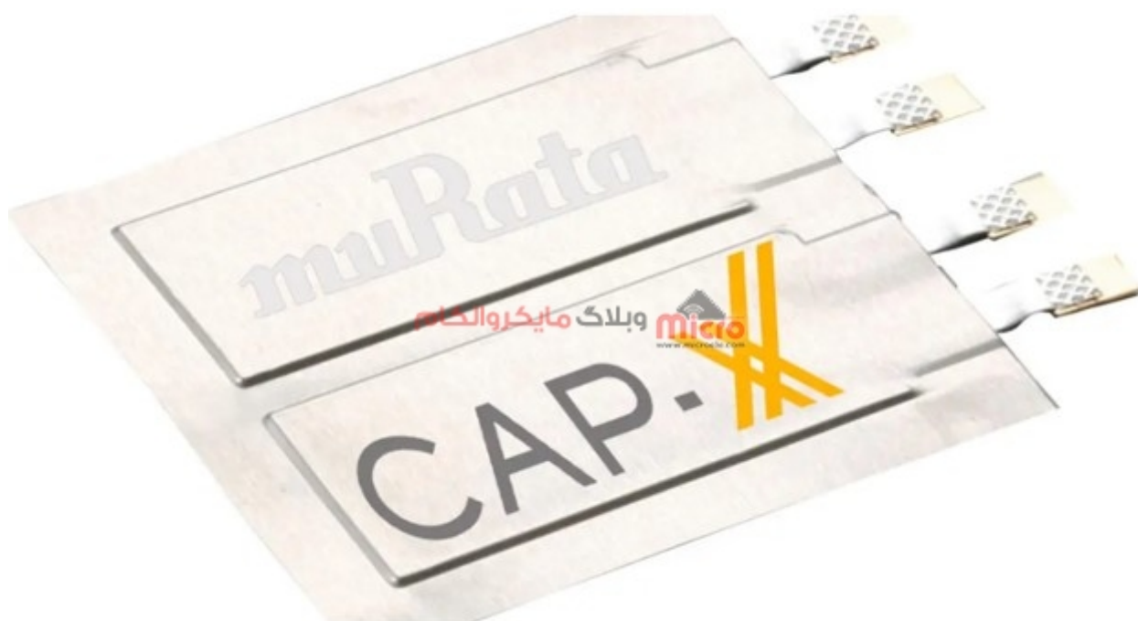
ابر خازن یا super capacitor
